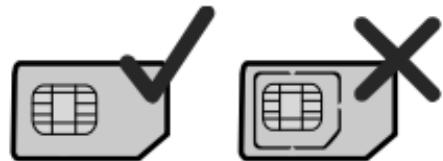
Setzen Sie die SIM-Karte entsprechend der Abbildung ein
